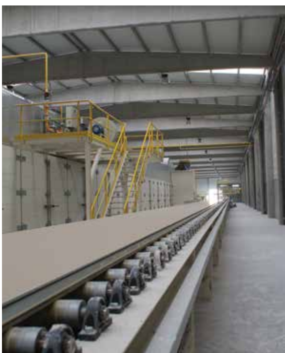
Figura 1: Fabricación de las placas de yeso laminado.
